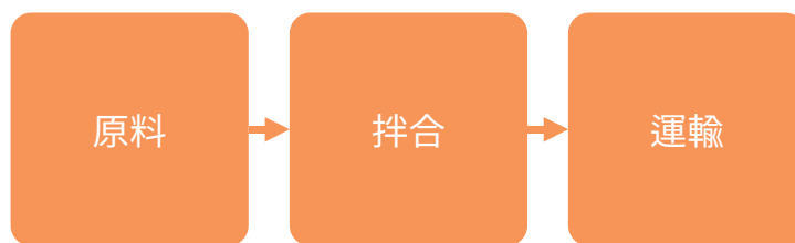
圖 13、預拌混凝土製造流程示意圖
